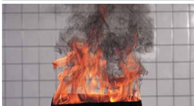
Testfeuer 5: Flüssigkeitsbrand (n-Heptan)
