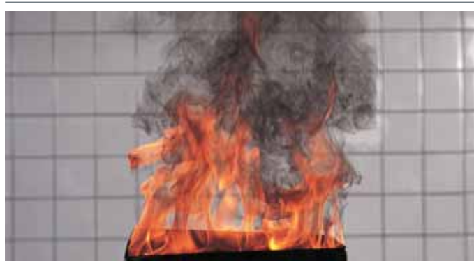
Testfeuer 5: Flüssigkeitsbrand (n-Heptan)
